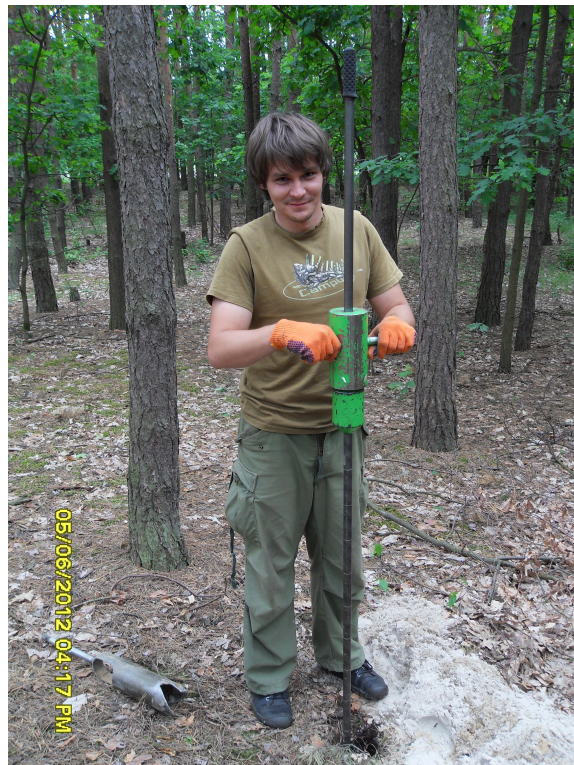
Zdjęcie nr 3 Sondowanie dynamiczne (DPL) przy otworze nr 1
